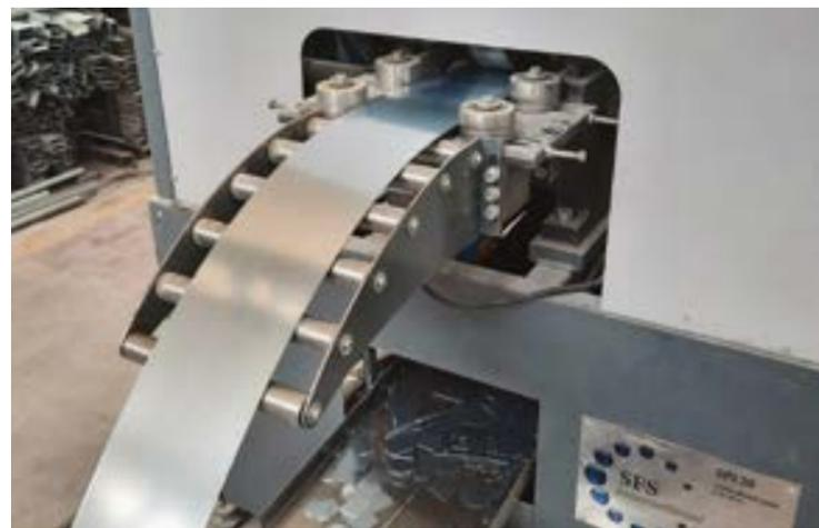
La macchina a controllo numerico (profilatrice) viene alimentata con una lamiera d'acciaio e riceve le istruzioni direttamente dal modello BIM per individuazione e modellazione automatica di tutti i particolari attraverso i plugin
